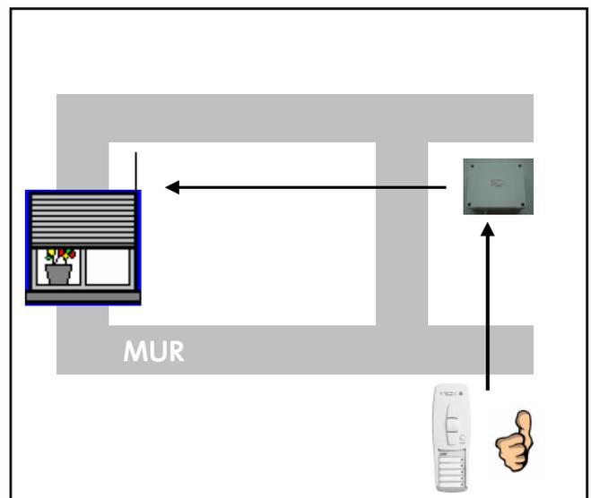
Les appareils munis d'une antenne de réception interne ne doivent pas être installés sur le même mur que l'émetteur. L'idéal est de les installer sur le mur opposé ou attenant.
